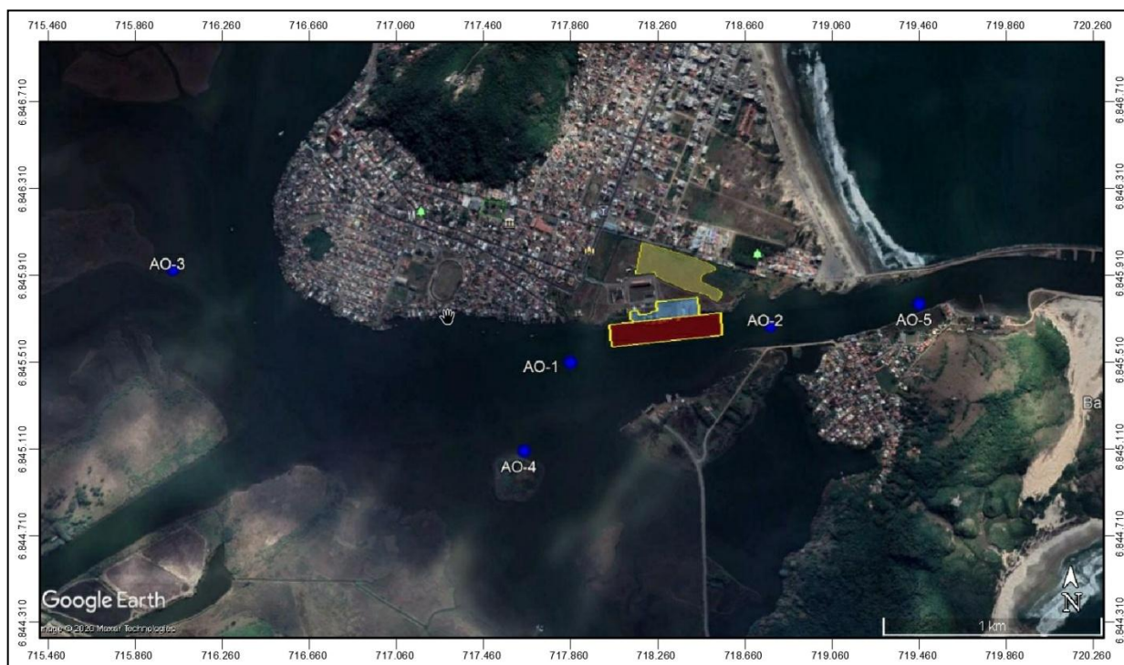
Figura 11 – Mapa de pontos de monitoramento das águas oceânicas para operação e dragagem do Terminal Pesqueiro de Laguna – SC.
