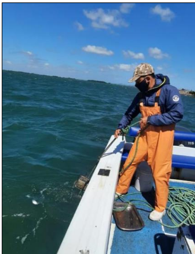
Figura 5: Coleta da amostra de sedimento utilizando o busca fundo modelo Petersen no Terminal Pesqueiro de Laguna/SC.
