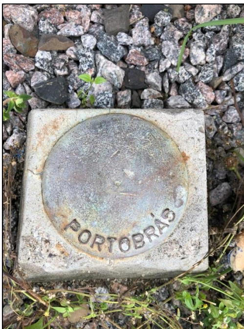
Figura 6: Detalhes da Referência de Nível “RN2-INPH Portobrás” utilizada no procedimento de redução dos dados batimétricos.
