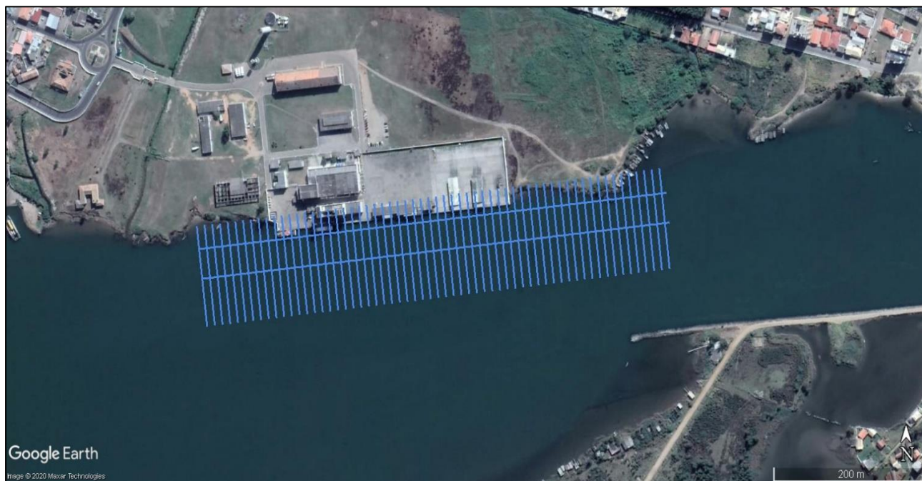
Figura 1: Plano de linhas de navegação elaborado para a coleta de dados batimétricos na região adjacente ao cais do Terminal Pesqueiro de Laguna.
