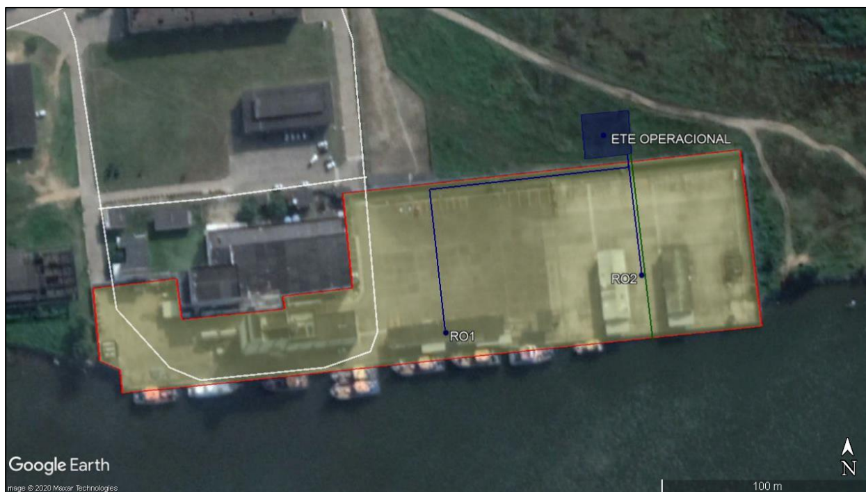
Figura 11: Linhas de recalque efluentes operacionais
