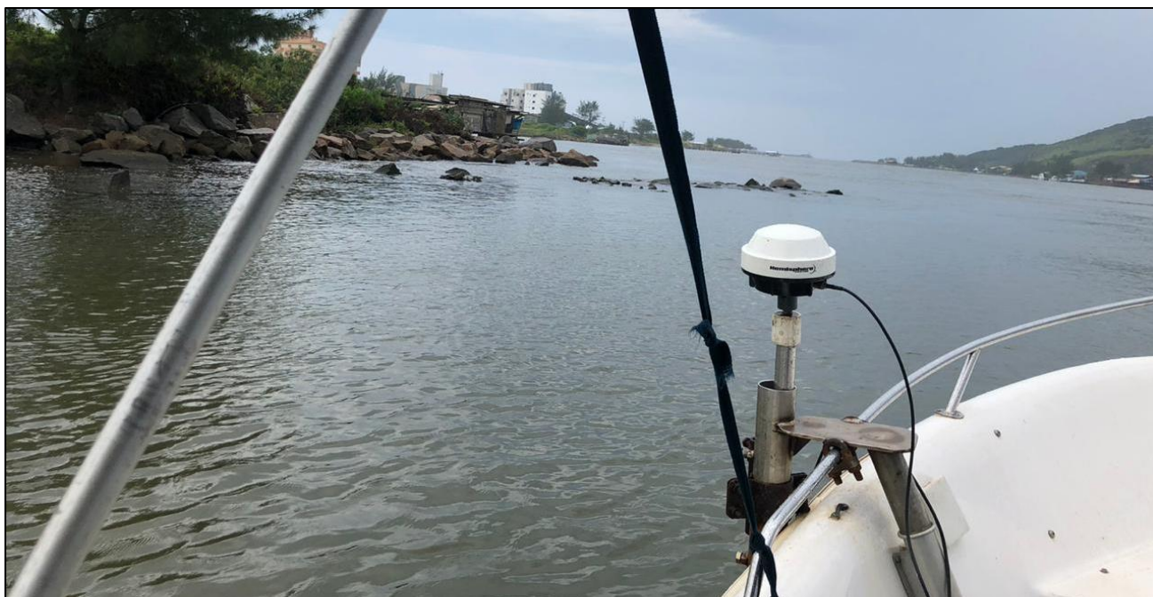
Figura 5: Antena GPS Beacon Hemisphere R130 utilizada no levantamento.
