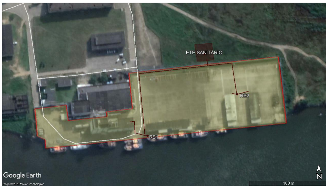
Figura 10: Linhas de recalque efluentes sanitários
