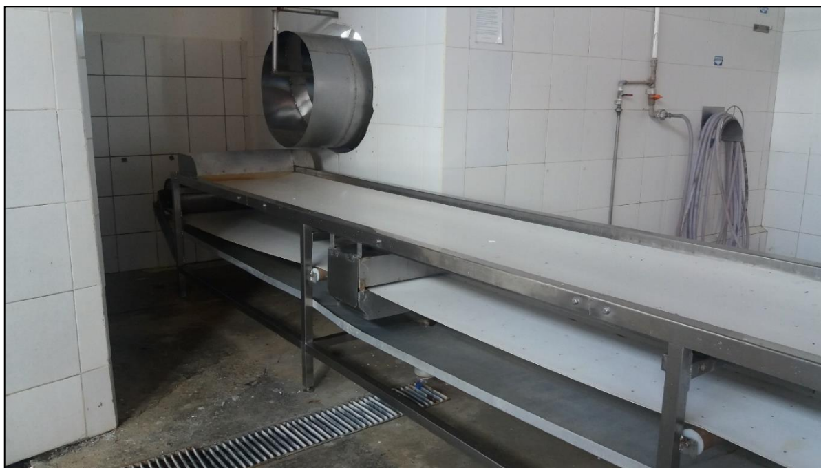
Figura 7: Esteira para recepção e seleção dos pescados
