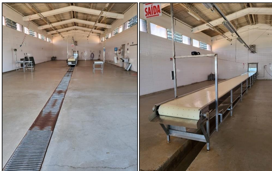
Figura 21. Interior do salão 3 com detalhe da esteira para recepção e seleção do pescado.
